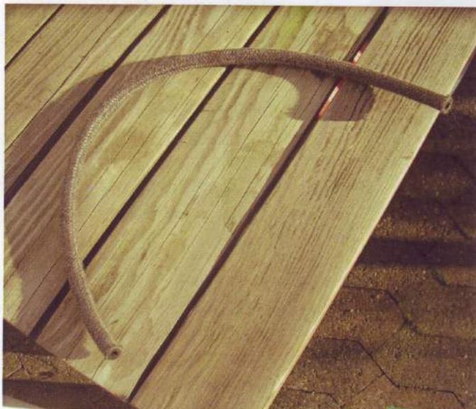
Hvornår har du sidst checket dine benzinslanger? Problemet er, at hvis de er af ældre dato, vil det moderne additiv i benzin'en opløse slangegummiet, med det resultat, at gummi-partikler vil forurene benzinsystemet og i værste fald foranledige alvorlige driftsforstyrrelser. Slangerne kan også revne, og benzindampe eller væske strømme ud og evt. forårsage brand.
